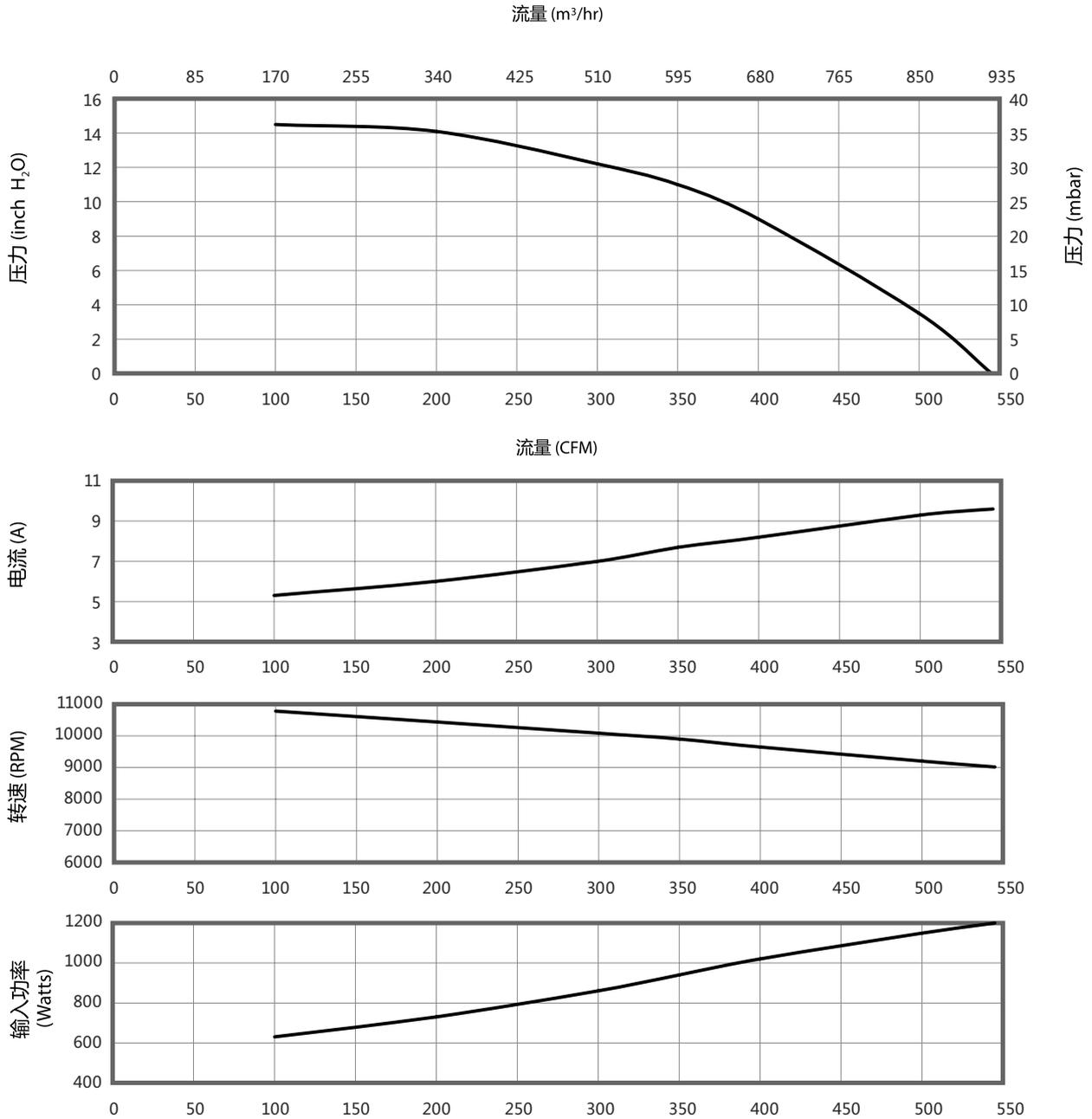
风机参数基于风机使用于标准空气密度, 1.2千克每立方米 (101.32千帕, 海平面, 20°C)。
